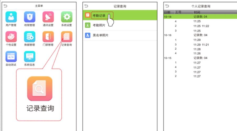
点击待机界面 > **记录查询**，进入记录查询界面。员工考勤成功后记录将保存在设备中，通过记录查询可方便查阅员工是否有考勤。
