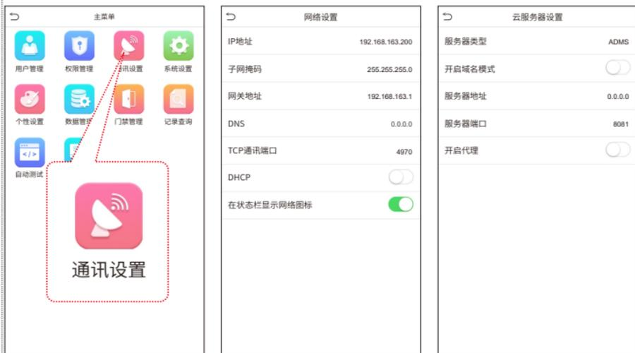
点击待机界面 > 通讯设置 > 网络设置，进入网络设置界面，对以太网网络地址参数等进行设置。若设备TCP/IP通讯成功，设备待机界面右上角显示通讯成功图标 。
