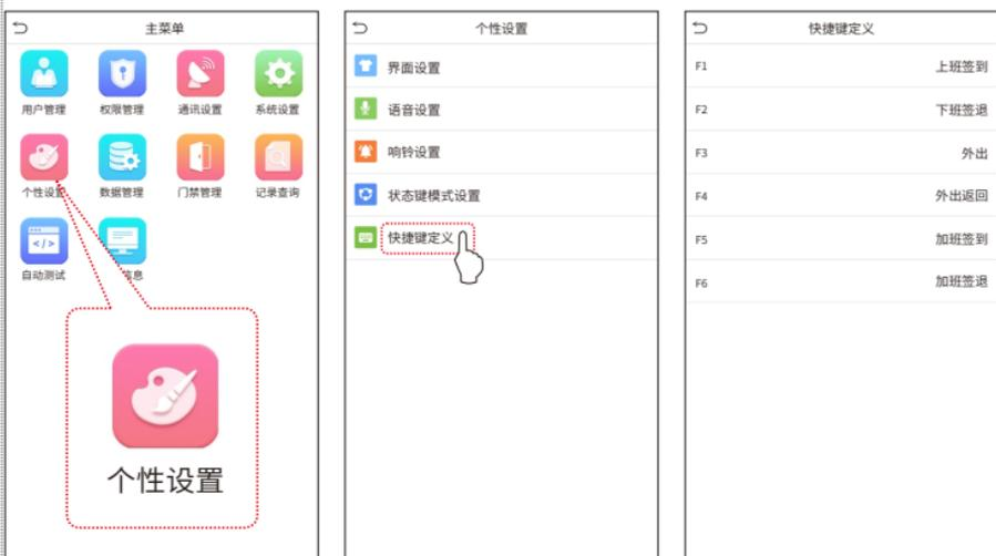
点击待机界面 > **个性设置** > **快捷键定义**，进入快捷键设置界面。可以将屏幕快捷键定义为考勤状态键或者功能键。点击屏幕无图标的任意位置，将会出现定义的快捷菜单键。
