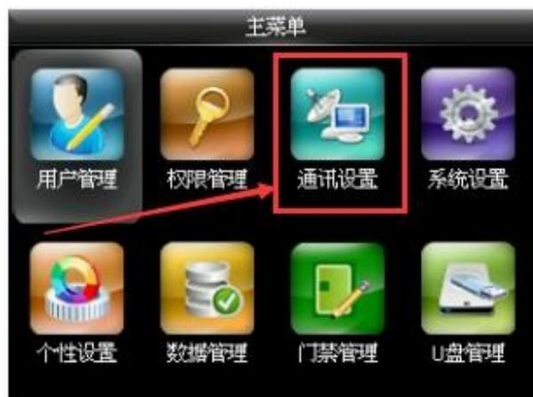
③、网络设置--IP 地址（这边的 ip 设置成和电脑本地连接里面的前三位一样，最后一位不一样。比如：电脑是 192.168.1.103，门禁一体机就可以改成 192.168.1.201）如果 DHCP（自动获取）是 ON（开启）的话要记得 OFF（关闭），否则 IP 改不了。
