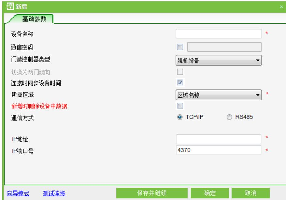
4、测试连接。设置完之后，先点击测试连接，成功说明正常通讯，再点击确定。
