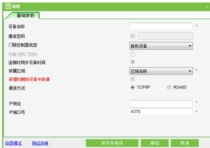
5、测试连接。设置完之后，先点击测试连接，成功说明正常通讯，再点击确定。
