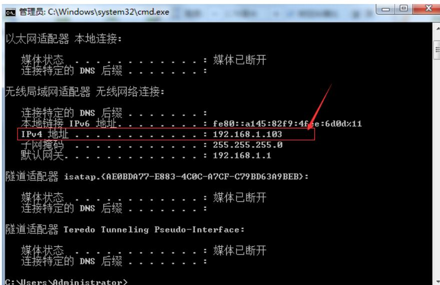
2、设置门禁一体机 IP 地址。把机器的 IP 改成和电脑本地连接里面的 IP 前三位一样，最后一位不同，也就是同一网段。比如：电脑是 192.168.1.103，考勤机就改成 192.168.1.X。X 代表最后一位跟本机电脑不一样且局域网内其它电脑也没有占用的 ip 地址。（**如何查找没有被占用的 IP**——在打开的 cmd 命令提示符中输入：ping +空格键+ip 地址+回车，例如：ping 192.168.1.201，如下图：出现这样的提示则为 ping 不通，说明这个 ip 地址没被占用，可以设置到考勤机上。还是不懂的话可以找公司网络管理员协助处理。）
