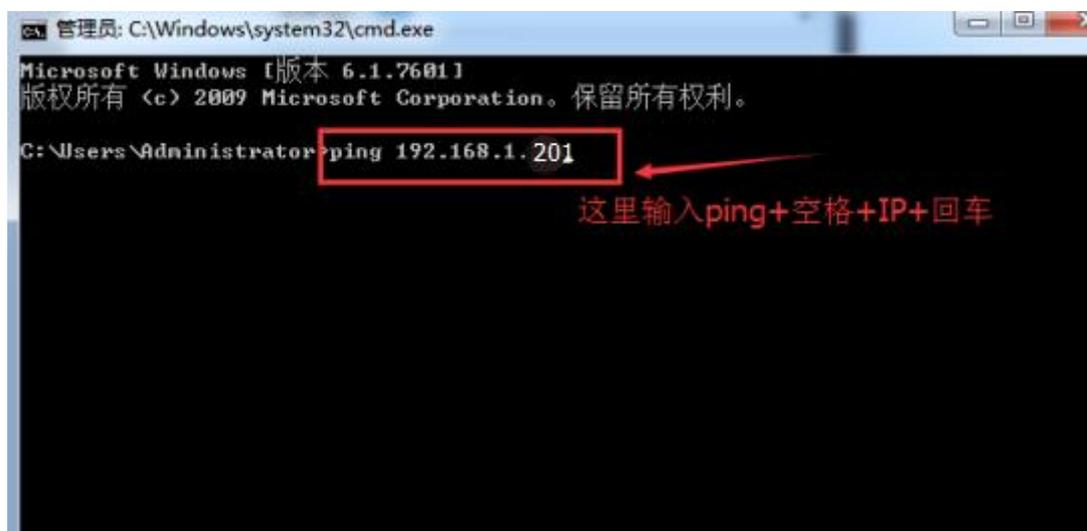
④、如果出现连续几行来自这个 ip 的回复，则说明这个 ip 地址能 ping 通，没被占用，就可以在考勤软件里连接设备了。如下图：
