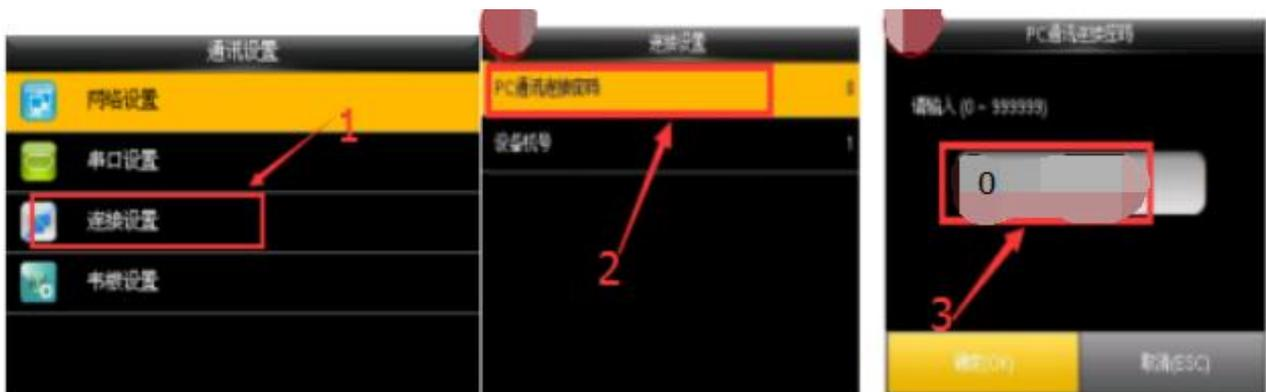
3、判断 IP 地址是否可以使用的办法。机器设置好了之后，再到电脑的开始--运行，填 cmd 确定跳出黑框输入：ping +空格键+机器 IP 地址+回车（例：ping
