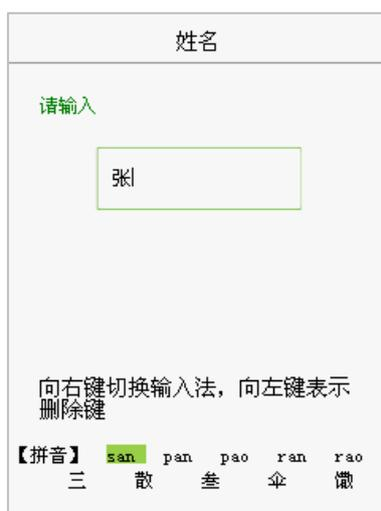
本设备支持中文、英文、数字及符号的输入。按【◀】键进行删除，按【▶】键切换输入法，按【▲/▼】键进行选择，按【M/OK】键确定，点击【ESC】退出输入。
